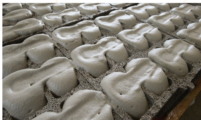
Bloc béton Alkern rempli de mousse minérale AIRium de Lafarge.
